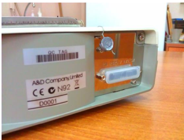
Рисунок 2 – Схема пломбировки весов
