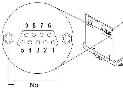
Наименования сигналов со стороны весов такие же, как со стороны DTE устройства с реверсивными TXD и RXD.
